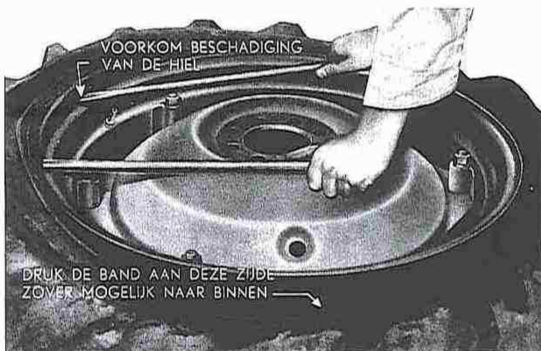
Afb. 14 — Het verwijderen van een band met bandenlichters
