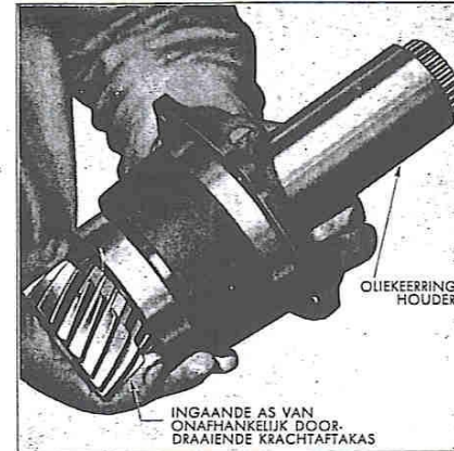
Afb. 3 - Montage van de ingaande as voor krachtaftakas.
